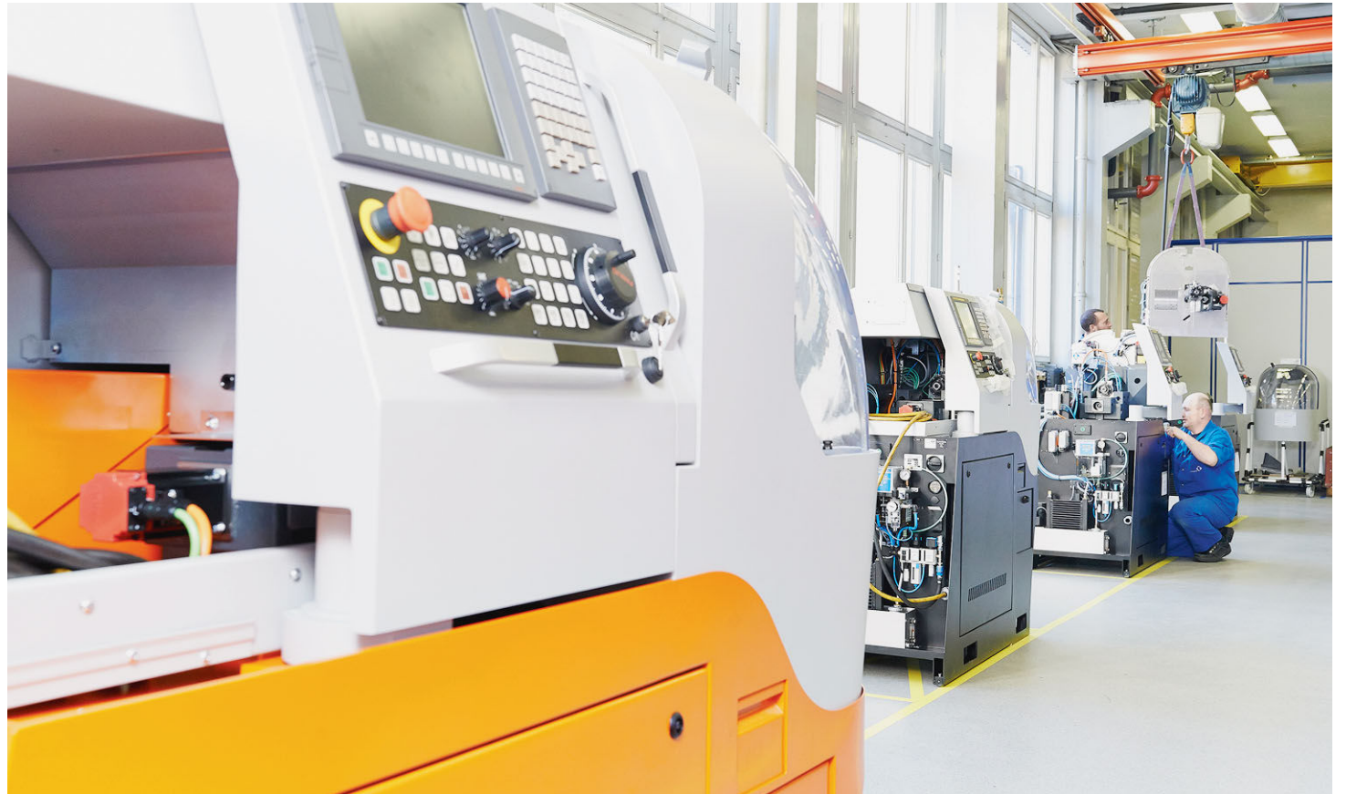
La SwissNano a été conçue pour le microdécolletage. Elle est fabriquée à Moutier selon le système de production lean manufacturing. ZELJKO GATARIC IMHOFF-LDD
